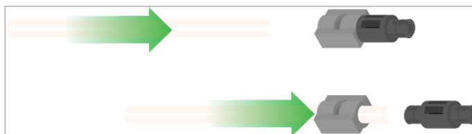
Usunięcie elementu dystansowego ze złącza dystansowego mini
